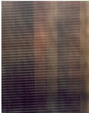
Vista completa de la cara frontal de un serpentín después de ser tratado con el Revestimiento HLF 815C659. El revestimiento presenta una base transparente única creando una variación de color en forma de reflexión solar resaltando de bronce a metálico claro.
