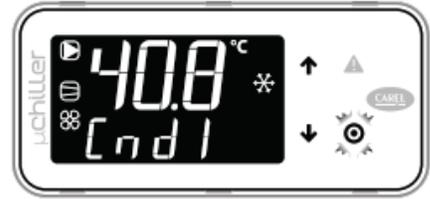
Pulsar ABAJO: Cnd1 indica la temperatura de condensación del circuito 1 (40,8°C).
