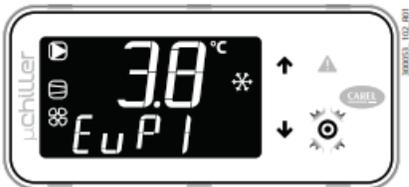
Pulsar ABAJO: EuP1 indica la temperatura de evaporación del circuito 1 (3,8°C).
