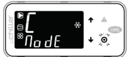
7. Pulsar ABAJO: aparece el comando para cambio de modo refrigeración (C) / calefacción (H) (ModE) - solo para unidades en bomba de calor.
