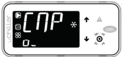
Pulsar ABAJO: CMP indica que el compresor 1 está encendido (o) y el compresor 2 está apagado (\_).
