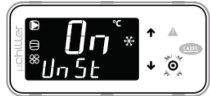
6. Pulsar ABAJO: aparece el comando de encendido/apagado de la unidad (UnSt).
